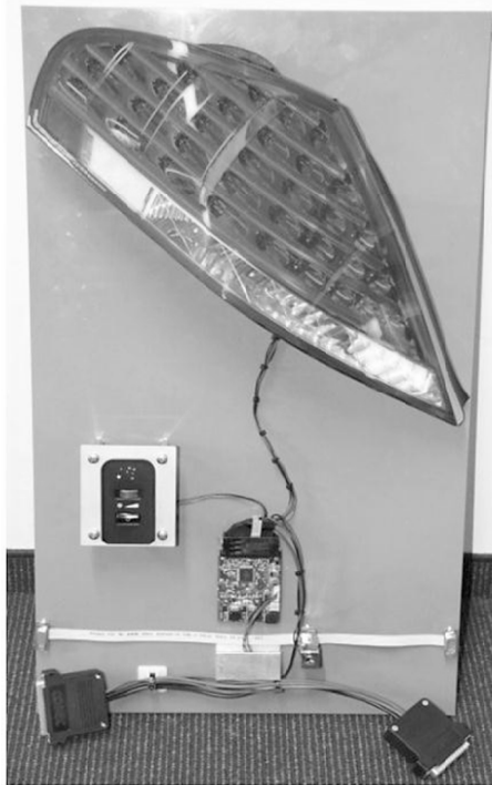
Abbildung 61: Lichtsteuerung - Sensorik, Aktorik und Steuergerät
